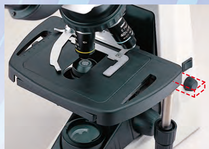
宽载物台表面没有架子伸出载物台
