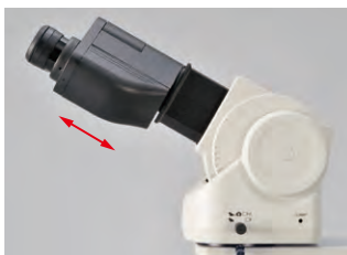
目镜长度可以延长达40 mm.
