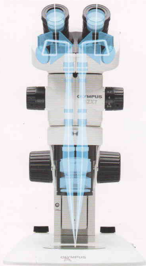
伽利略光学系统具备2条（左/右）独立平行变焦光学路径，能够提供出色的光学特性和系统模块化
