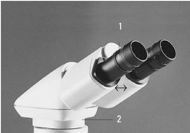
Abb. 47 Tubuseinstellung ↔ Einstellung des persönlichen Augenabstandes 1 Skala (mm), 2 Zwischenmodul*, im Bild: Ergomodul
