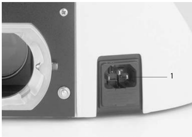
Abb. 27 Stativrückseite Leica DM2700 M 1 Anschluss Spannungsversorgung
