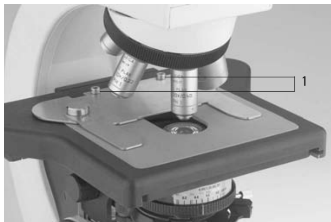
Abb. 3 Objektisch mit Präparatehalter
